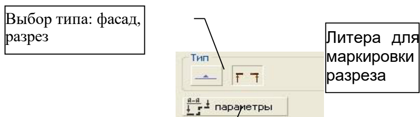
Рис. 3.22 Панель свойств инструмента Фасад / Разрез
